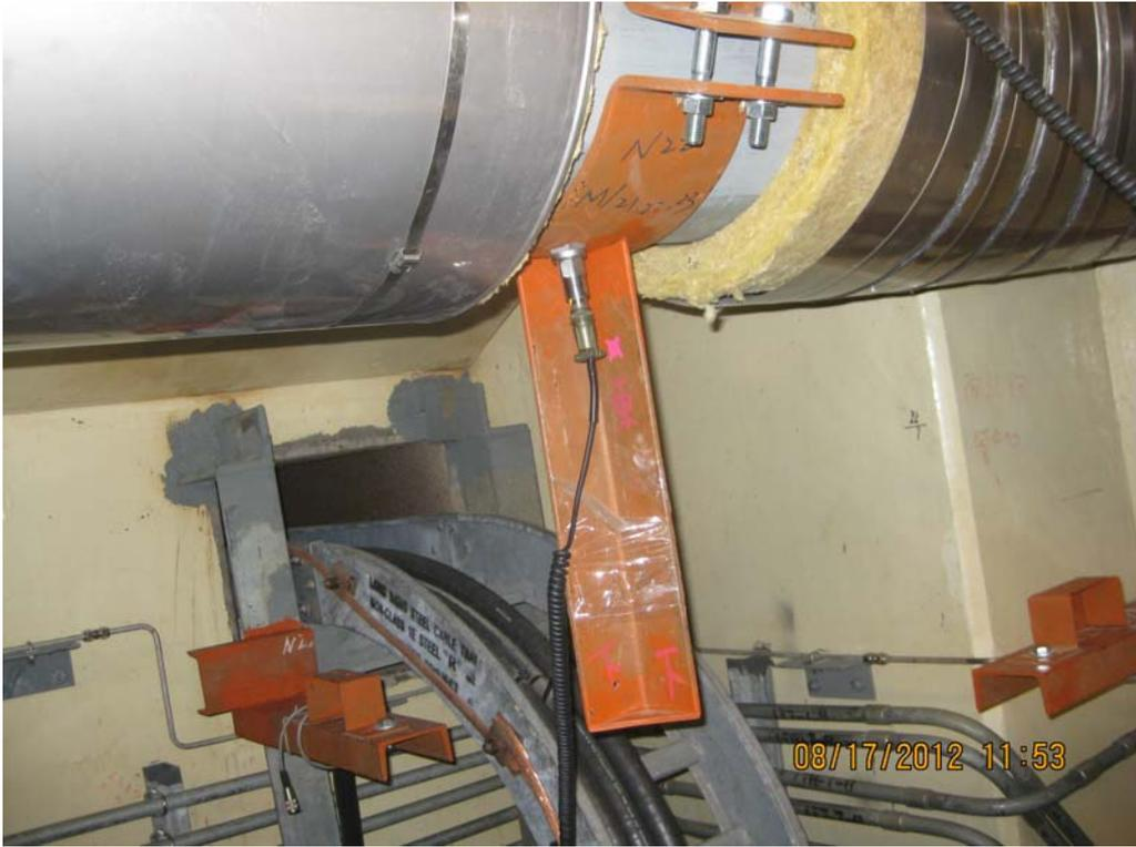
管路振動測量偵測器安裝情形
