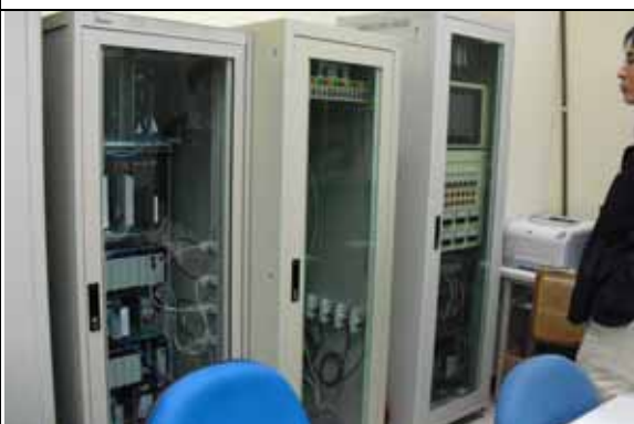
照片 8：PLC-Allen Bradley，Modicon Quantum，GE Fanuc
