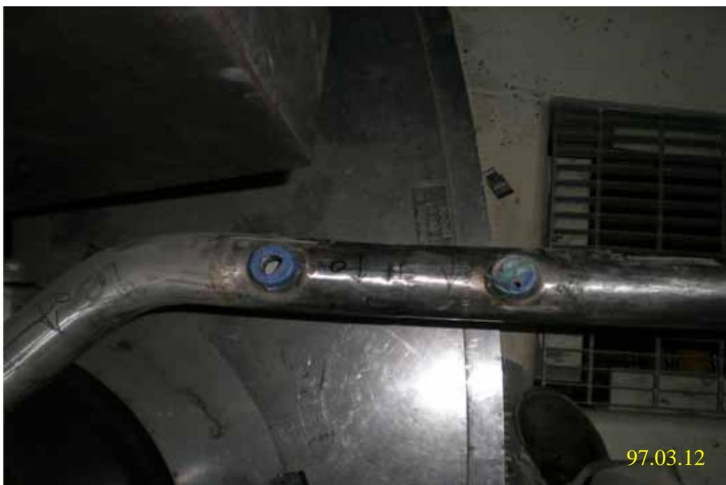
照片九：一號機 RIP 之 RMC 出口管路溫度量測孔封口破損情形
