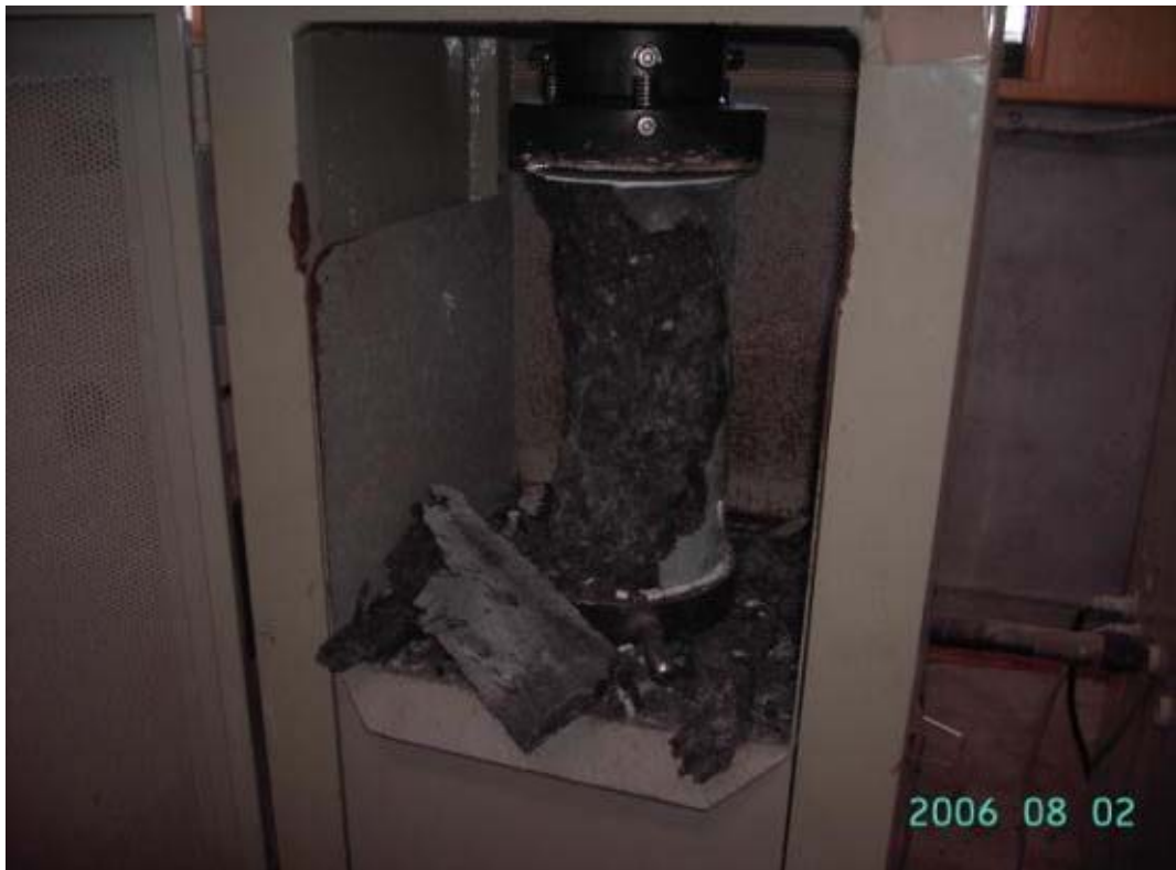
圖 12：混凝土試體抗壓試驗作業情形
