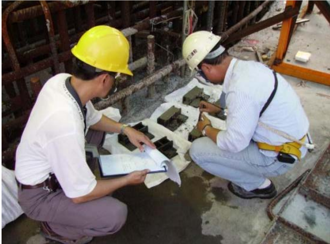
圖 7：二號機基座之 RPV 支撐座二次澆置不收縮水泥漿取樣情形
