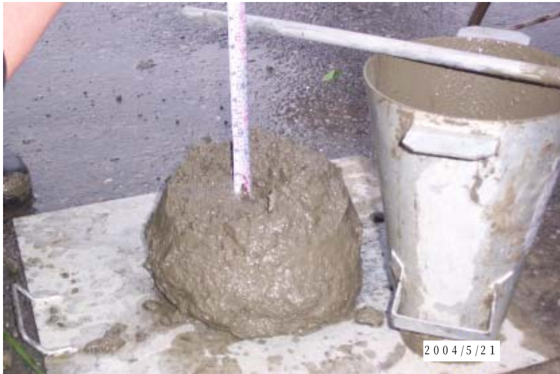
圖七：混凝土取樣進行坍度試驗情形
