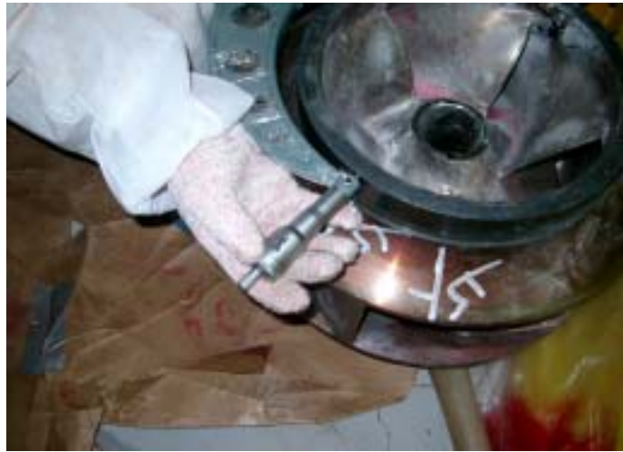
量測各零件運轉間隙及泵上、下軸直度(一)
