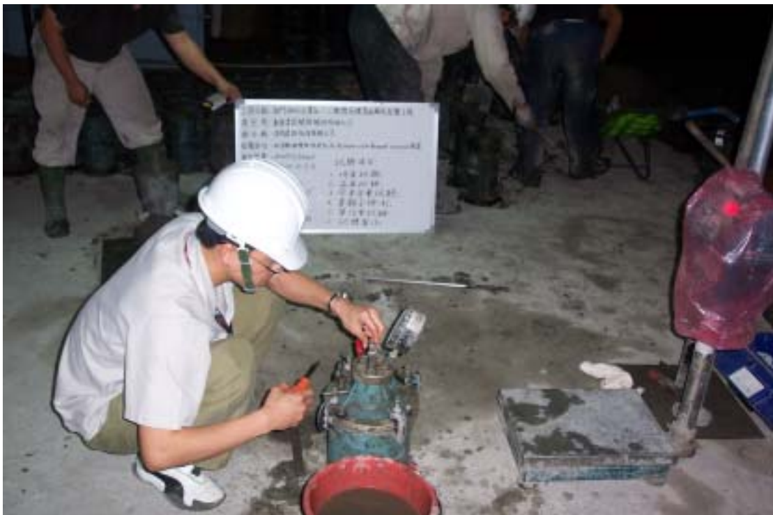
圖四：混凝土含氣量試驗現況（3/31 21：25）
