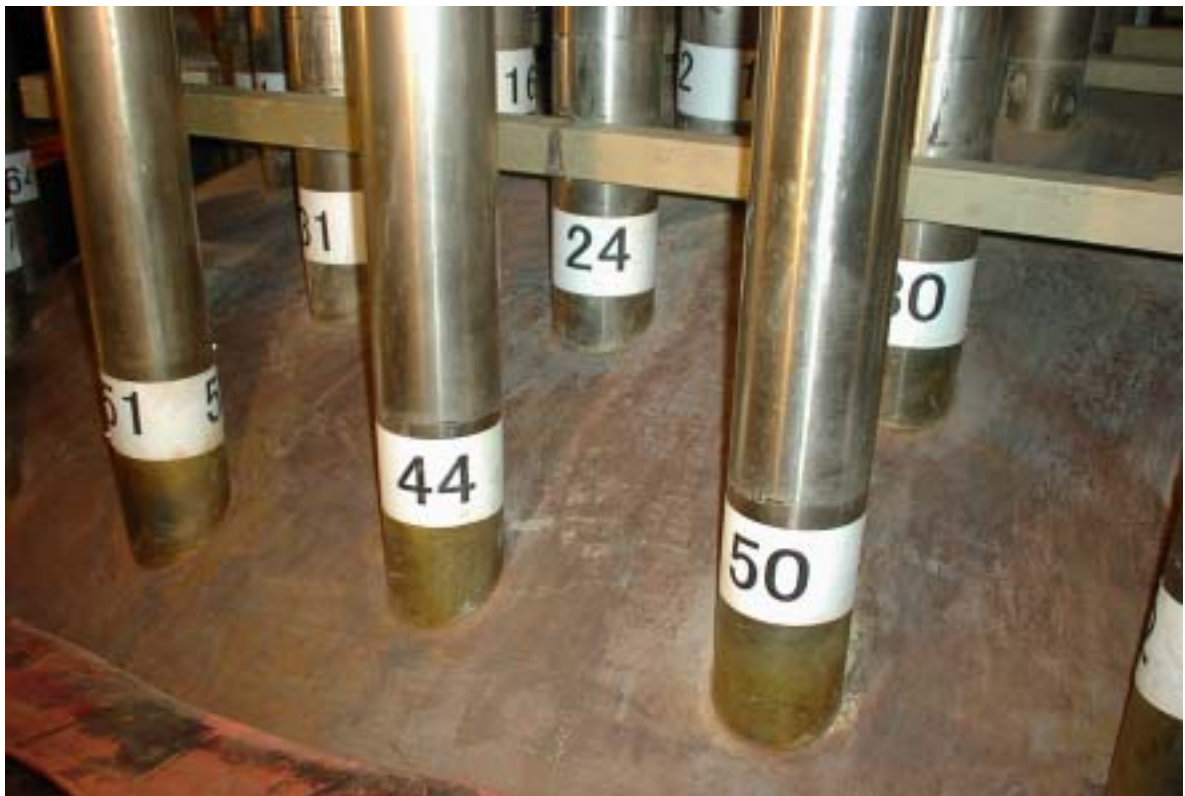
相片四 一號機爐蓋表面銹跡清除，其加工痕跡清晰可辨，爐 蓋母材無腐蝕現象
