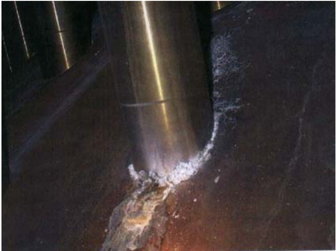
相片三 美國 Ocone 三號機反應爐槽爐蓋 CRDM 穿越管洩漏 周圍呈硼酸結晶之情形
