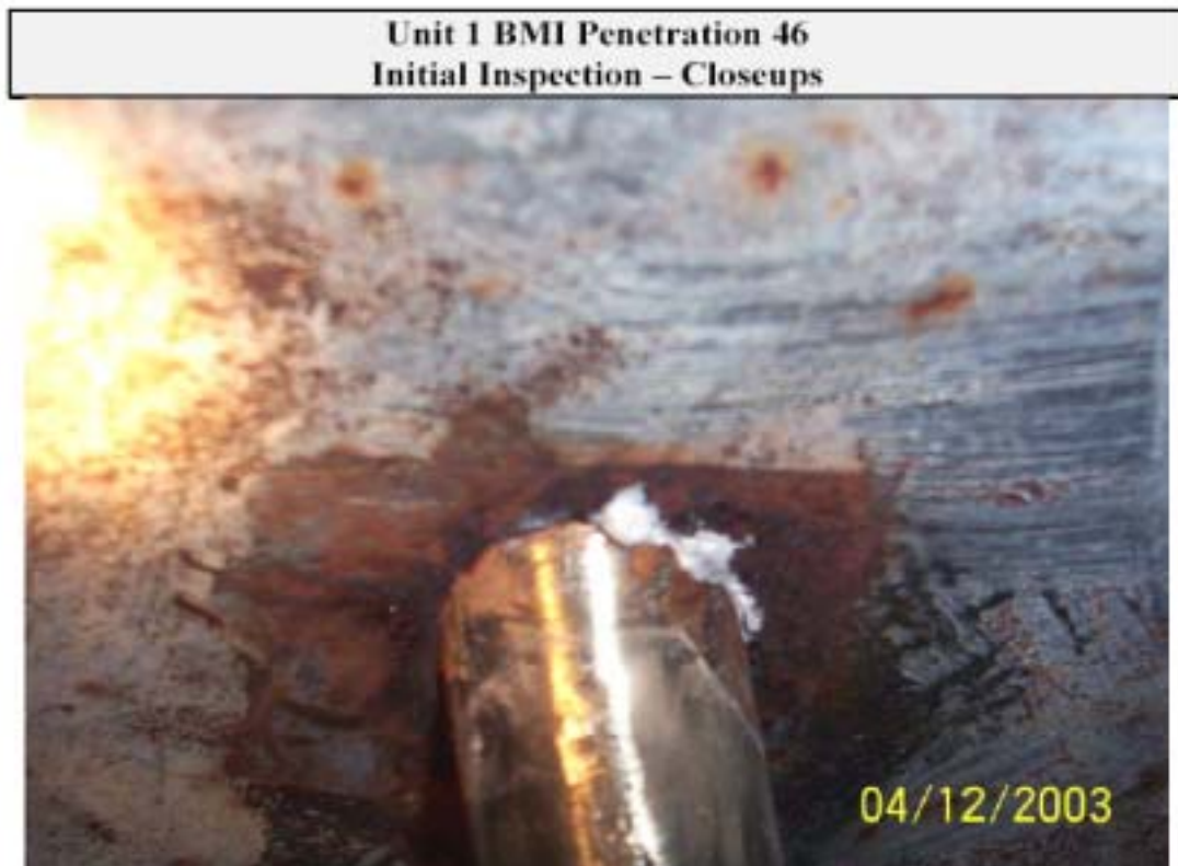
相片十六 美國南德州核電廠爐底穿越管洩漏情形
