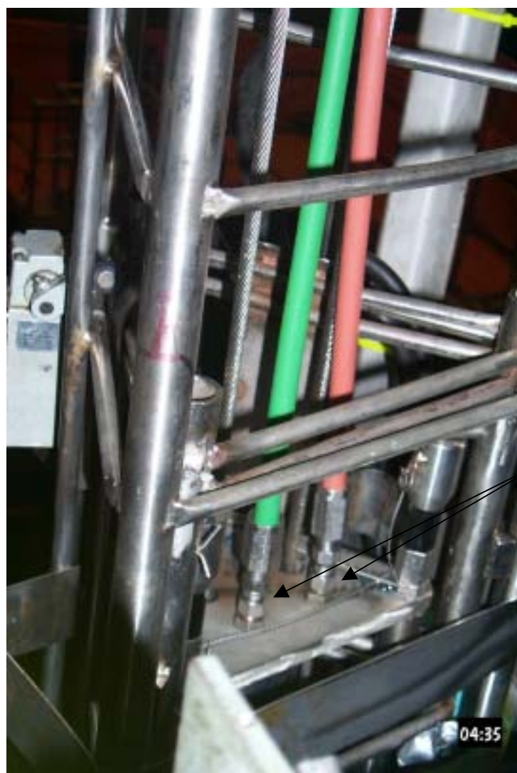
圖三 壓縮空氣軟管接反處
