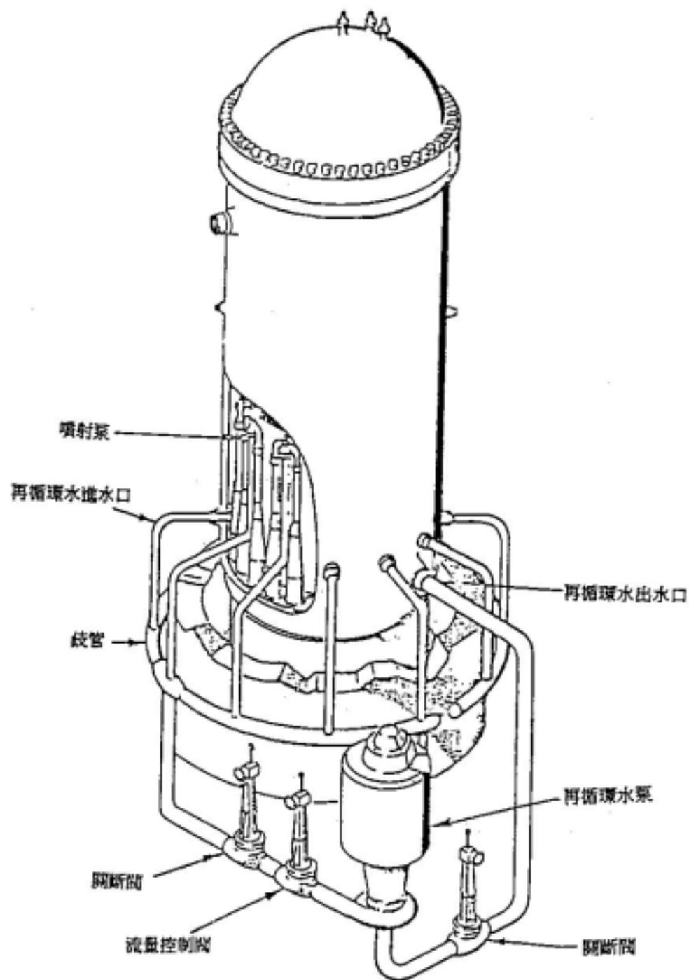
圖一 再循環水系統示意圖
