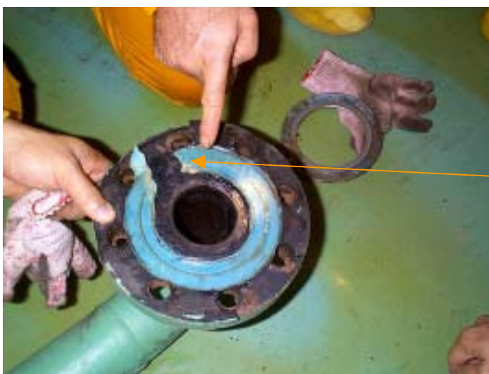
破損之石綿墊片
