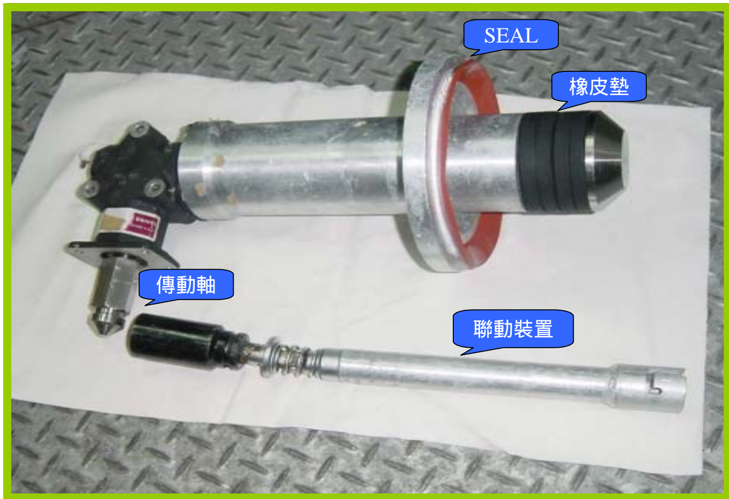
圖三 備用硼液控制系統硼液儲存槽出口管路栓塞
