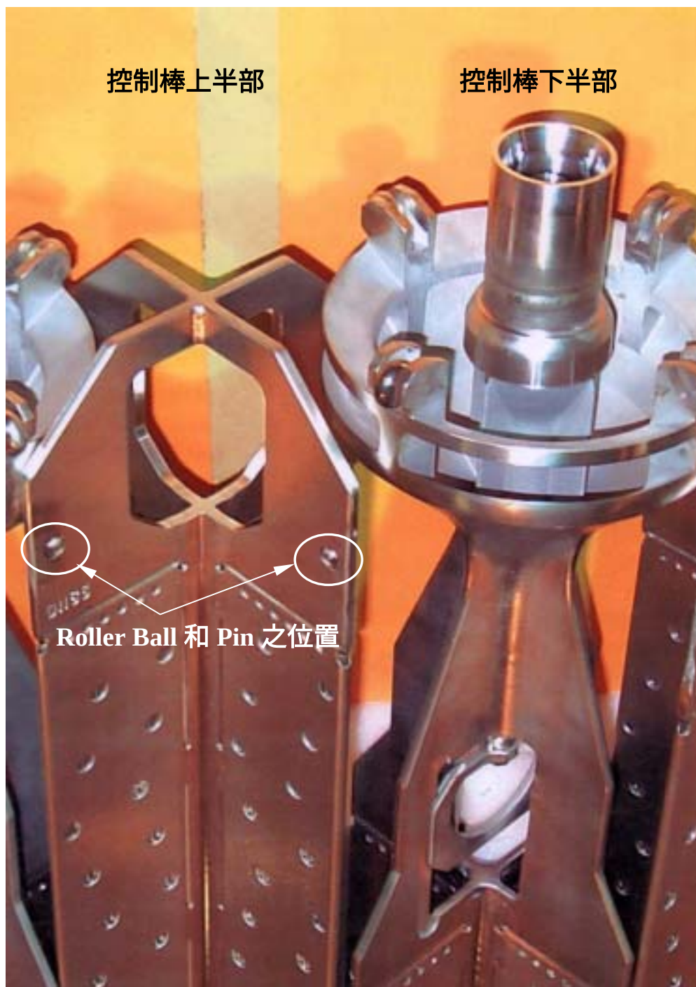
圖三 D-230 型控制棒之上、下半部外觀及 Roller Ball 和 Pin 之相關位置
