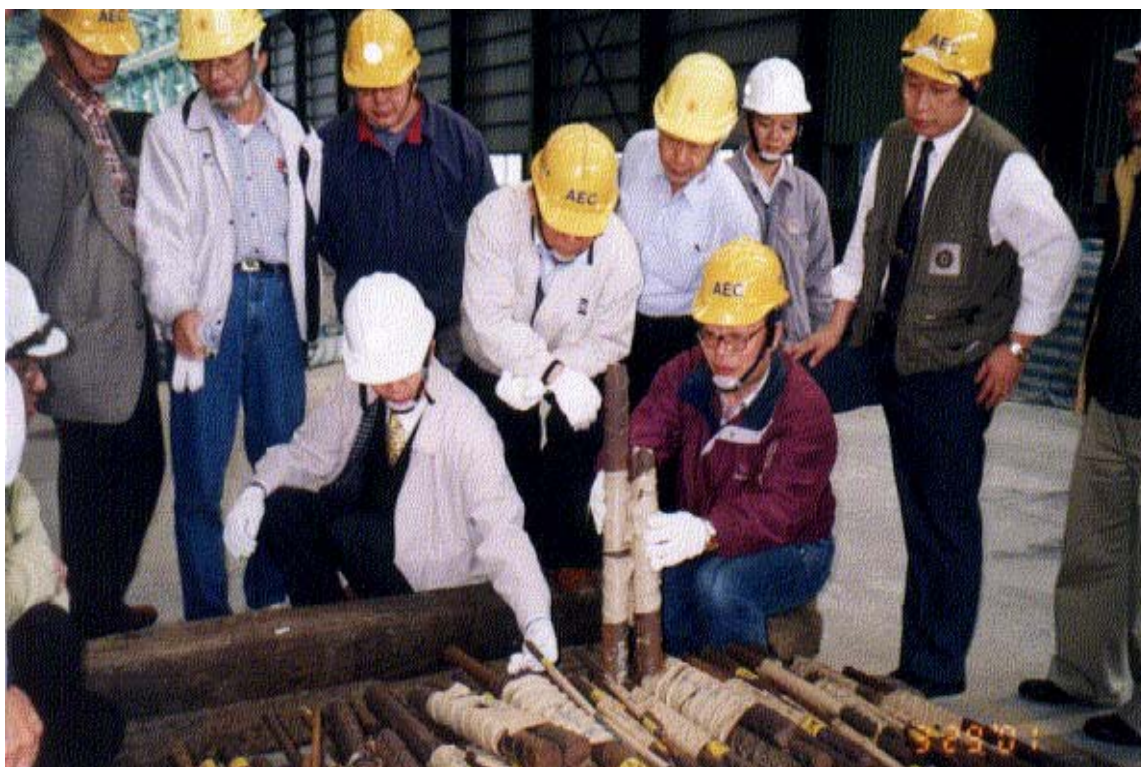
(圖三) 原能會會同專家學者赴現場實勘鋼筋取樣試驗後樣品破壞情形
