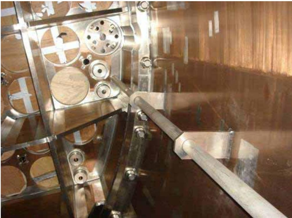
圖十 一號機反應爐內部從爐底上看爐心底鈹
