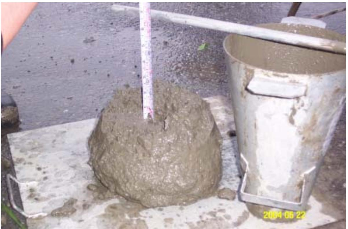
照片二：二號機RCCV Wall 混凝土澆置中取樣進行坍度試驗
