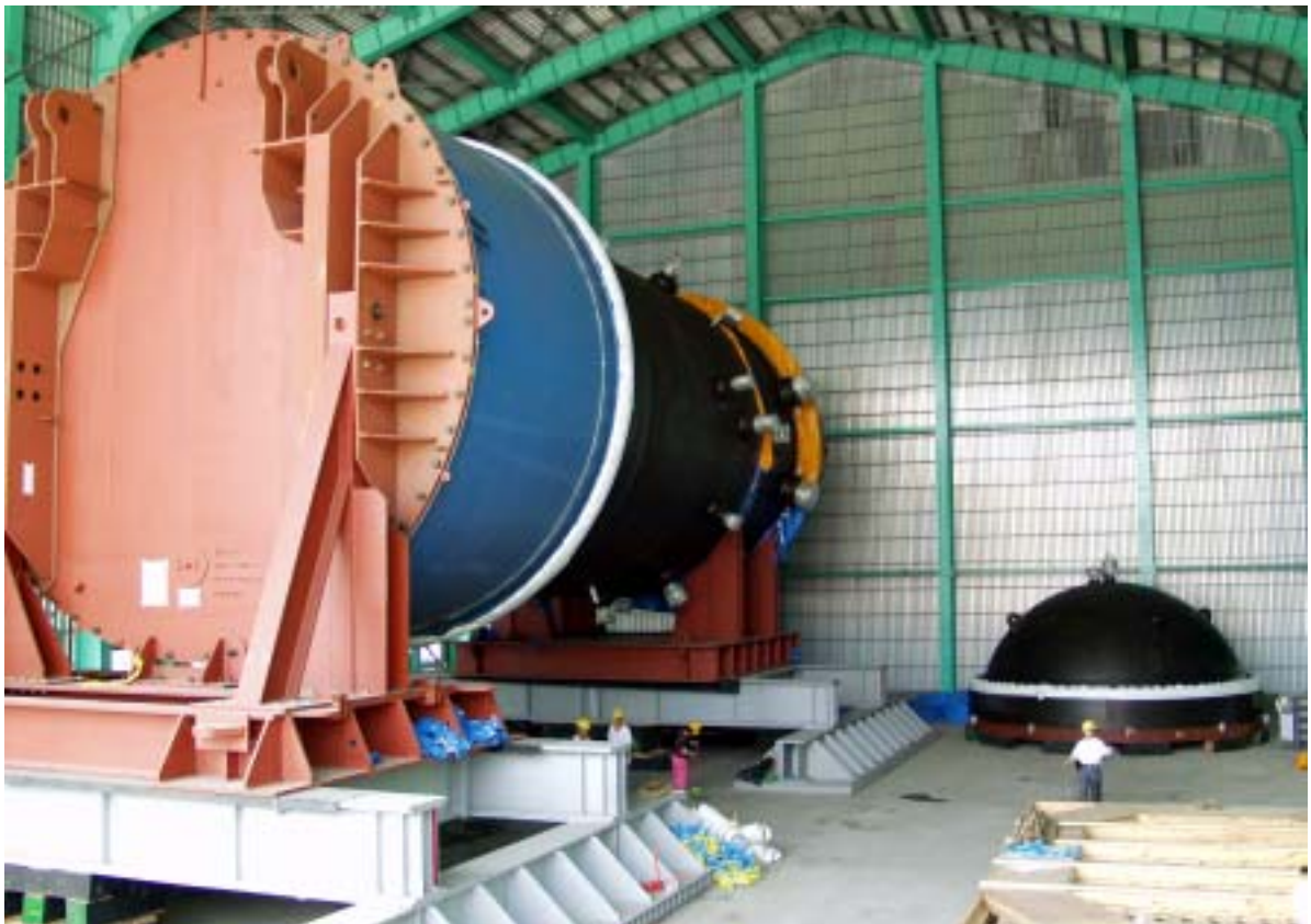
照片六：一號機 RPV 本體及頂蓋儲放於專屬臨時倉庫內情形
