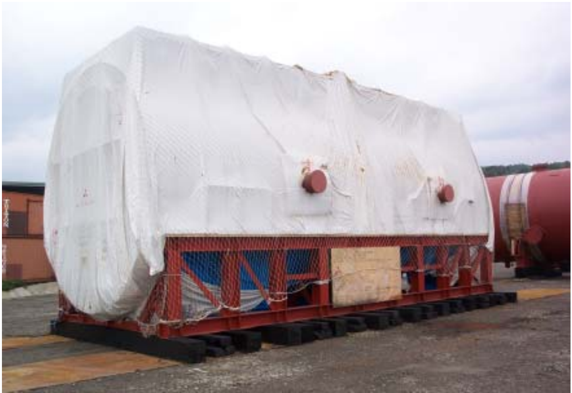
照片五：設備儲存管制查證-Generator Stator 為 B 級儲存等級， 儲存於 D 級重件儲存場現況
