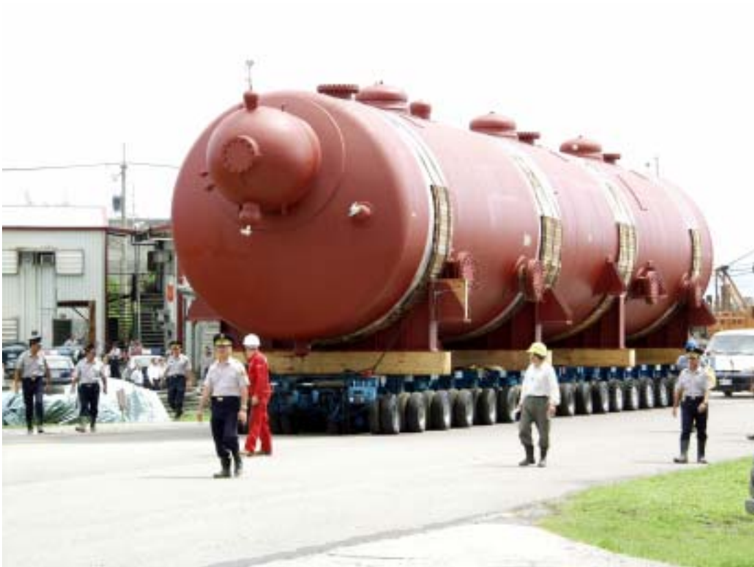
照片六：汽水分離再熱器運送狀況圖
