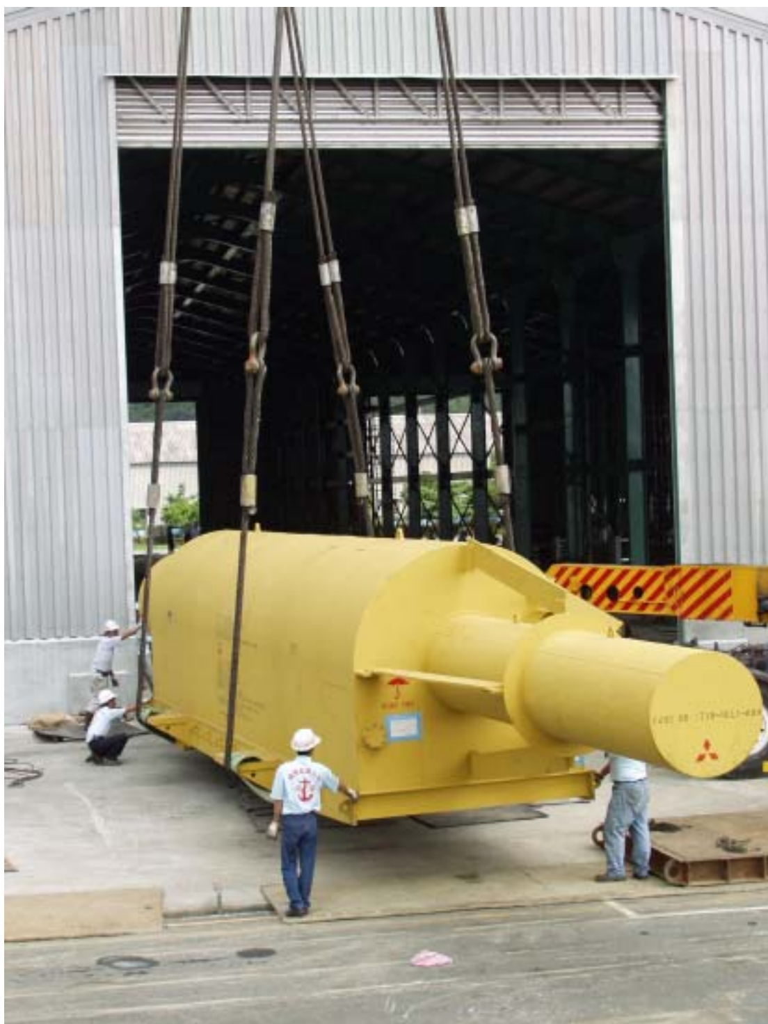
照片七：發電機轉子進庫搬運情形
