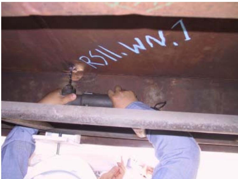
反應爐基座第一層鉚道鑽屑取樣作業
