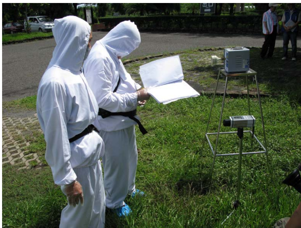
圖 4 直接環境輻射偵測與空浮微粒取樣計測作業
