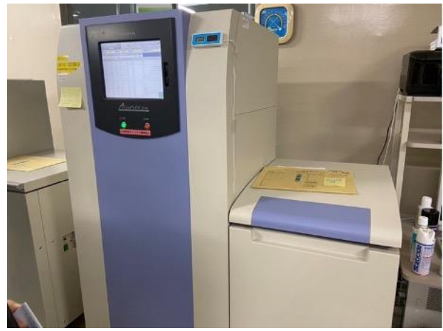
圖 27、ALOKA 的低背景液體閃爍計數器 (LSC) 外觀
