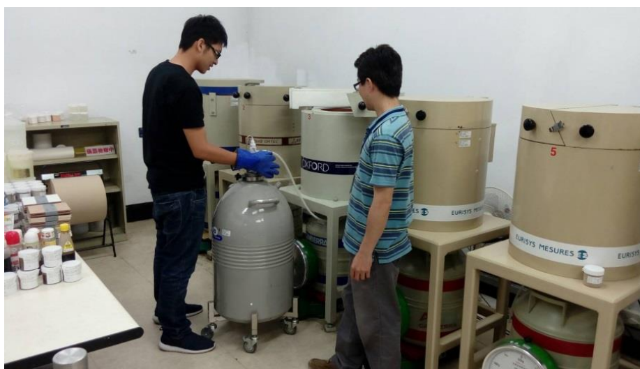
圖 13 純鍺偵檢器之維護-液態氮的補充與品管的操作
