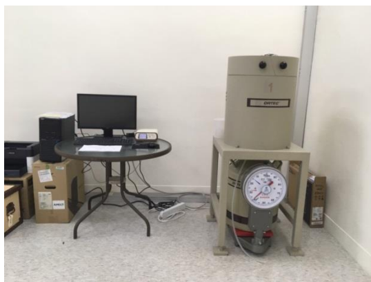
圖 2. 純鍺半導體偵檢器系統
