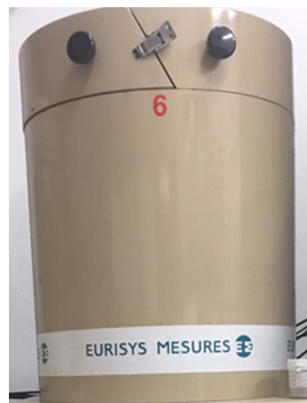
圖 4 純鍺鉛屏蔽結構介紹圖
