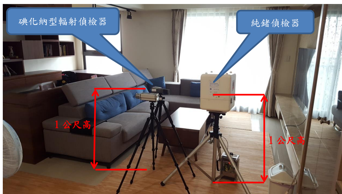
圖 5、室內地表輻射量測情形 (地點：高雄市小港區鋼筋混凝土住宅大樓)
