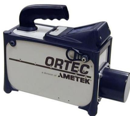
圖 8 ORTEC 手持式純鍺偵檢器
