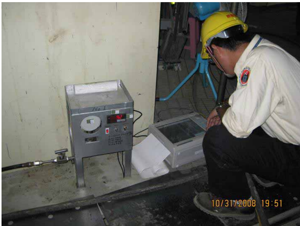
本會視察員對反應爐水壓測試現場壓力監測儀器紀錄器實地查證
