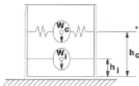
圖 2.6-0 沖擊模態中心高度與對流模態中心高度示意圖
