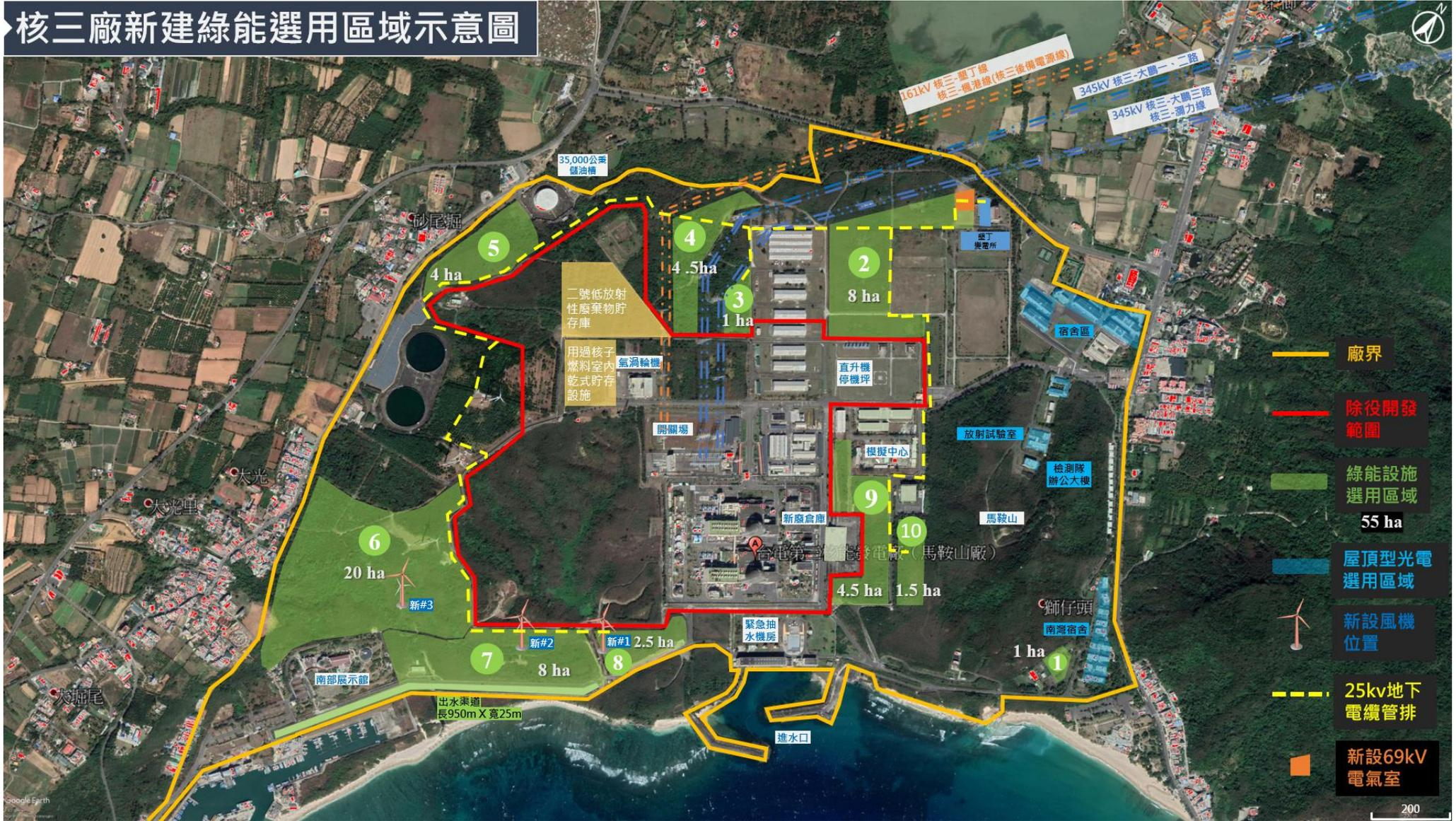
圖一 核三廠之風力發電及太陽光電佈置圖
