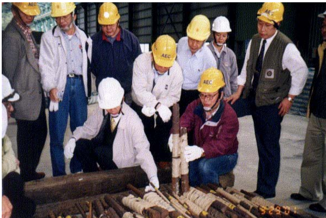
(圖九) 原能會會同專家學者赴現場實勘鋼筋取樣試驗後樣品破壞情形
