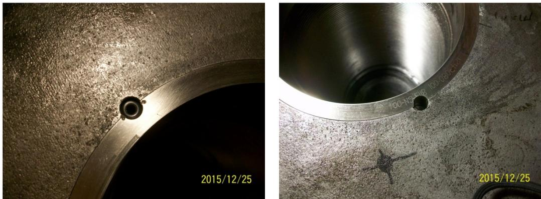
圖 10 完成之螺孔牙套與定位銷(dowel pin)
