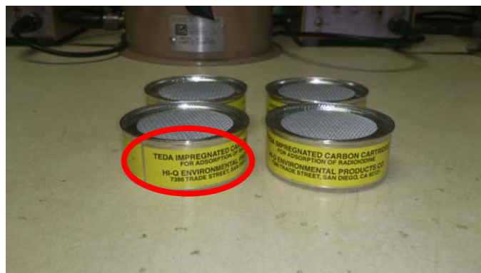
無標示之碘過濾罐
