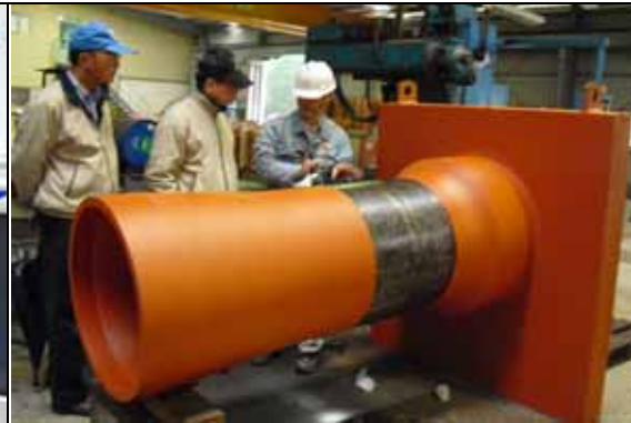
照片 10：RPV 主蒸汽延伸管 Mock-up
