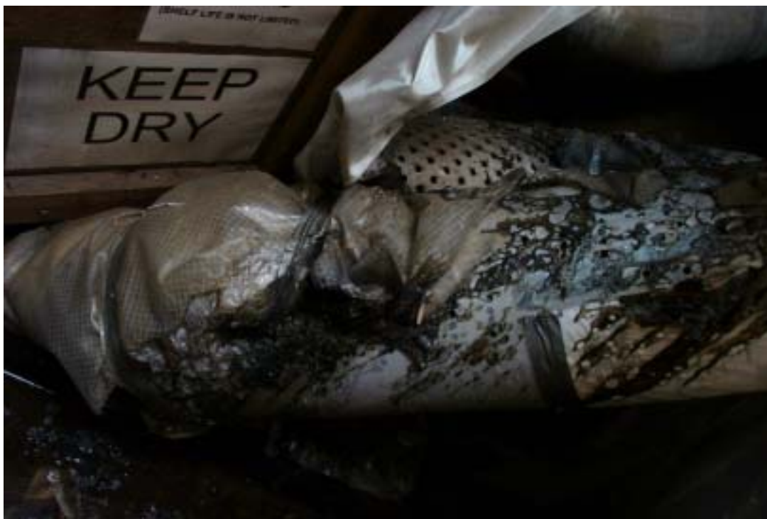
照片二、現場部分 Quencher 之保護膠套有灼傷焦黑之狀況
