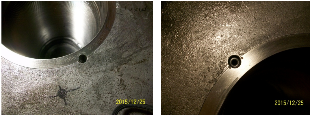
圖 9 完成之螺孔牙套與定位銷(dowel pin)
