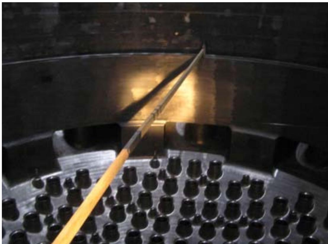
照片十四 鋼尺量測細鋼絲交會點之距離
