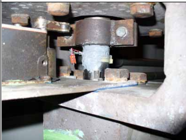
圖 9 訊號接線金屬頭裸露
