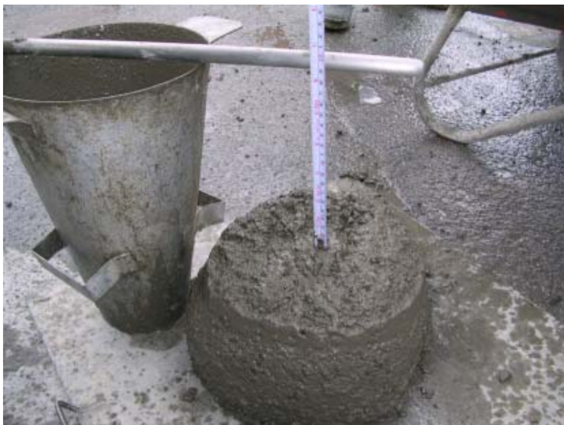
圖九：混凝土取樣進行坍度試驗情形
