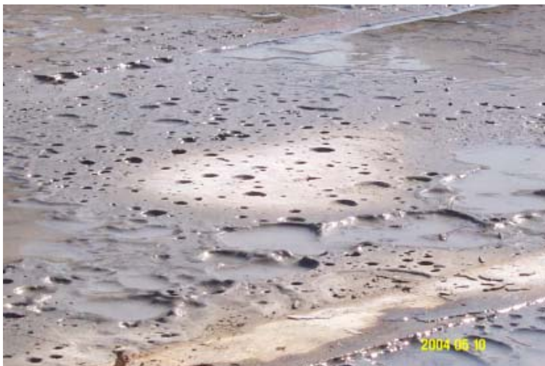
圖五：澆置性試驗表面情形
