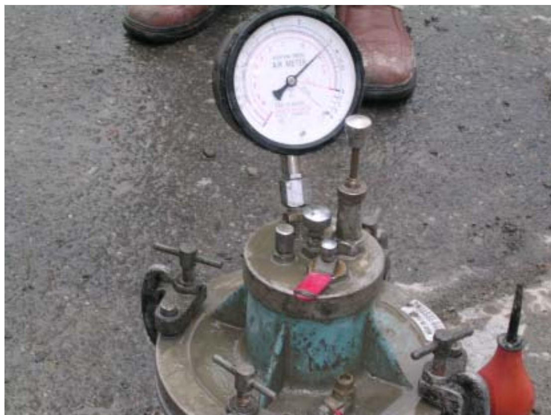
圖十：混凝土取樣進行含氣量試驗情形
