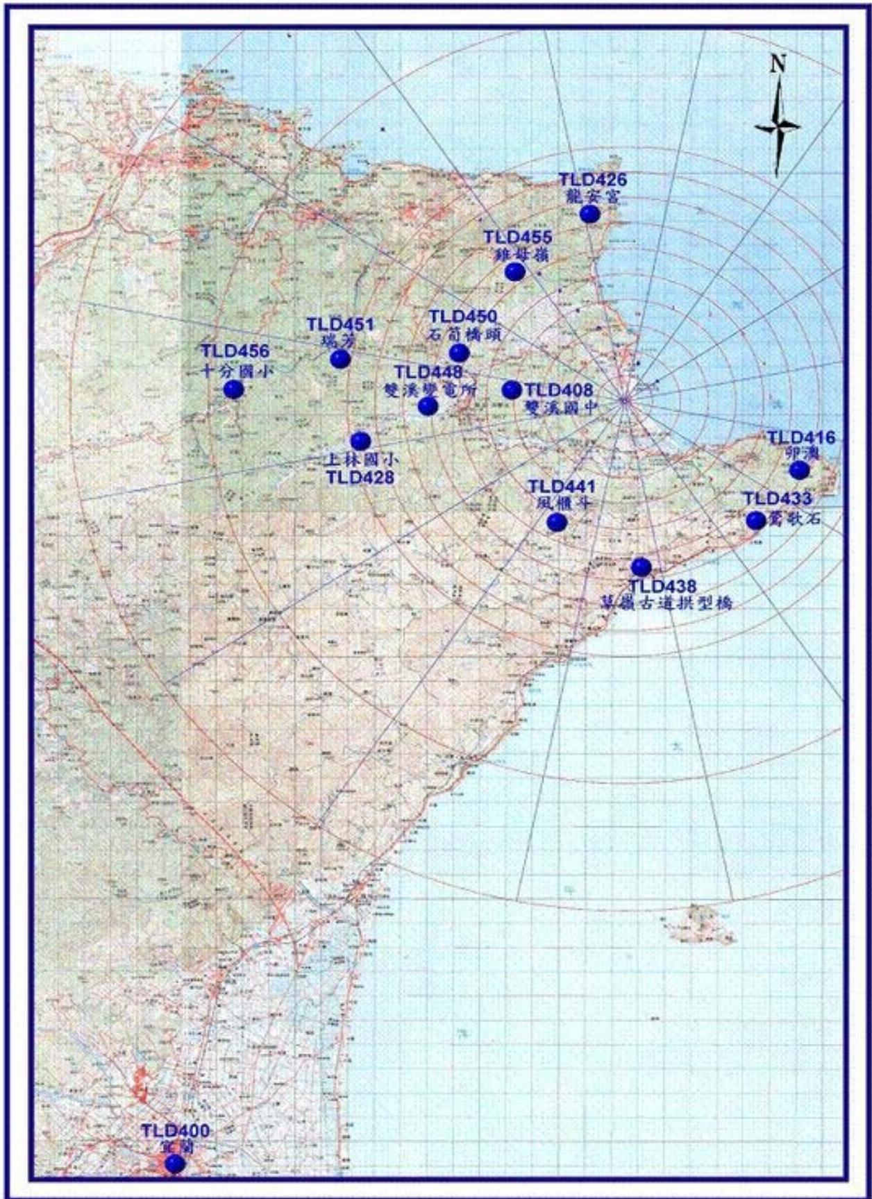
圖2 核能四廠熱發光劑量計監測站分佈圖(5公里外)
