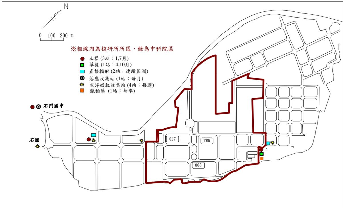
圖 1-1：核能研究所場所外直接輻射、空浮微粒、落塵、草、表土及龍柏葉等取樣點位置圖
