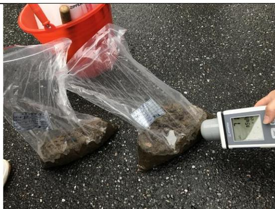
圖十四 減容中心上游排洪渠道B底泥樣偵測
