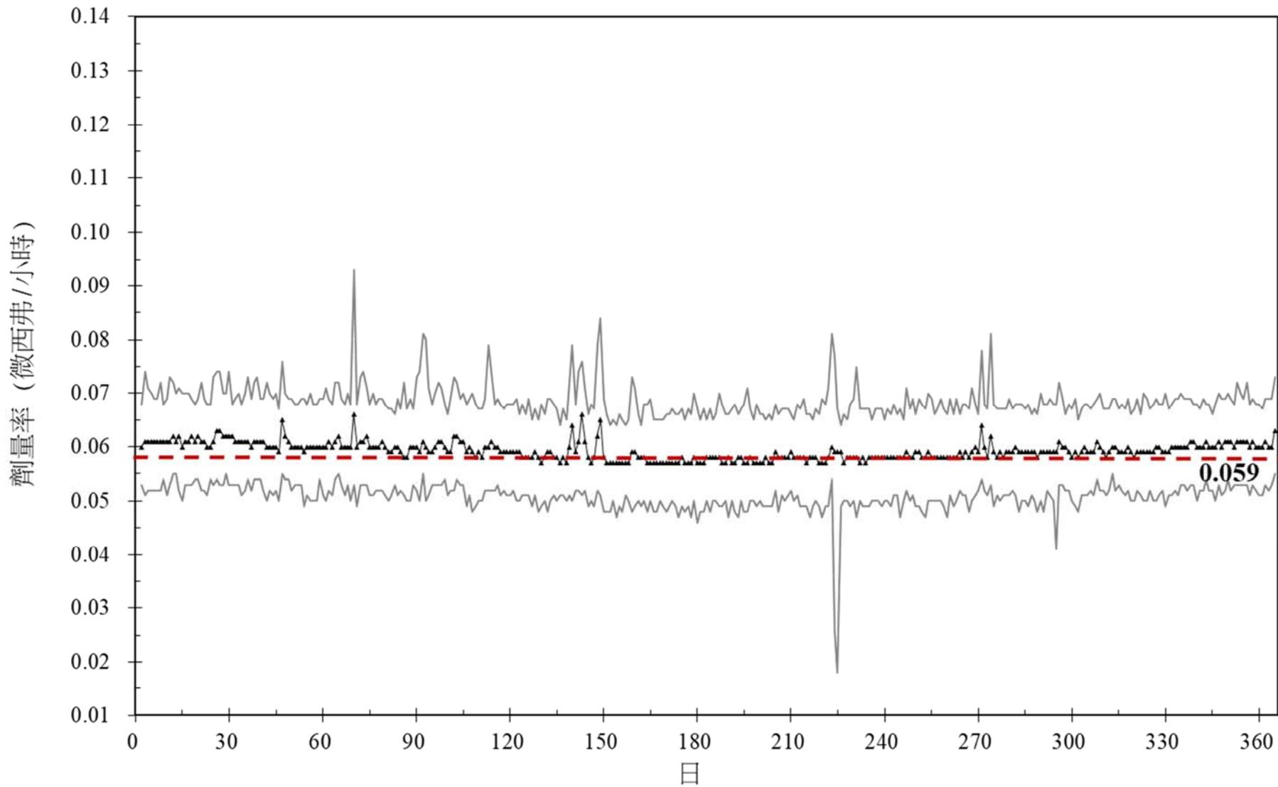
圖5 109年連續輻射偵測劑量率變動圖(加速器館)
