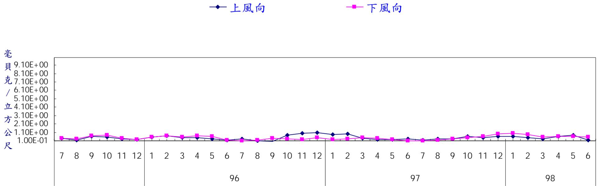
圖 15 核能一廠上下風向空氣微粒總貝他活度監測結果
