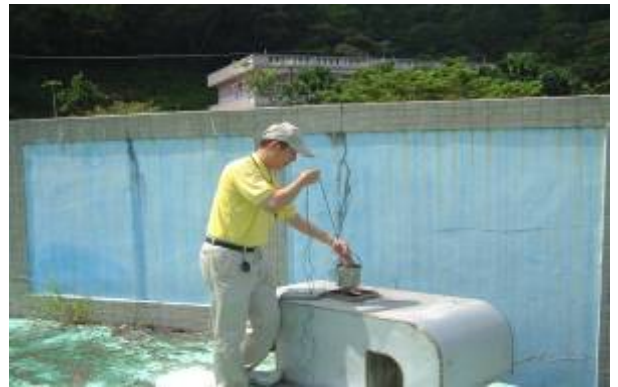
取樣點(自來水廠出水池)
