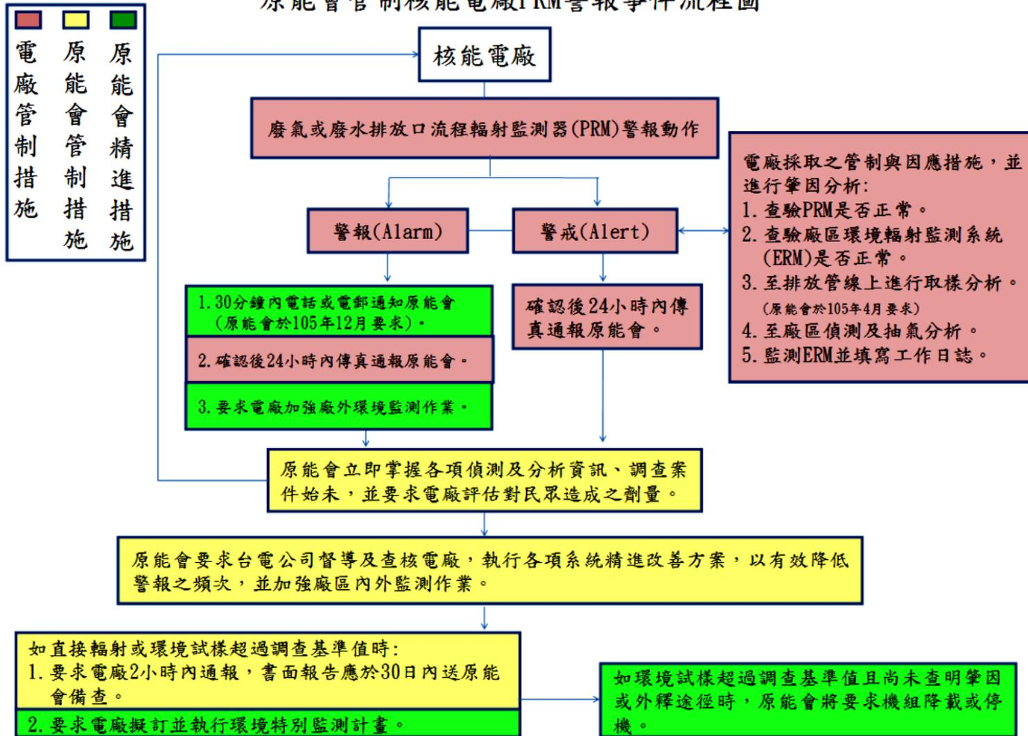
圖四、PRM 警戒/警報事件管制流程
