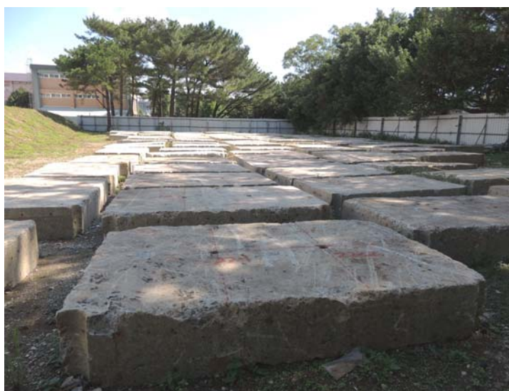
混凝土塊除污檢整、量測分析達解除管制標準
