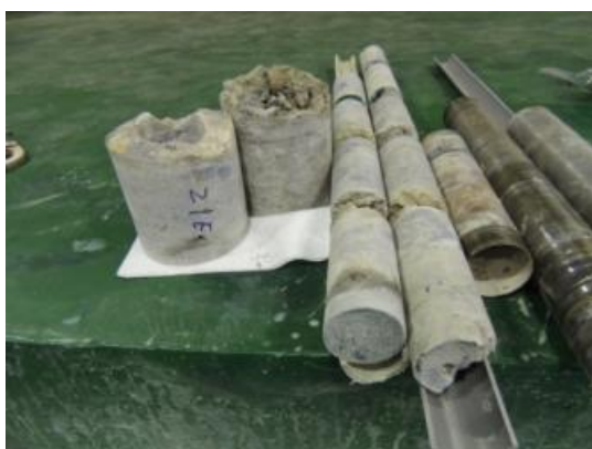
貯存場區上層水泥基座、貯存孔間回填土及貯存孔內鋼管污染調查作業
