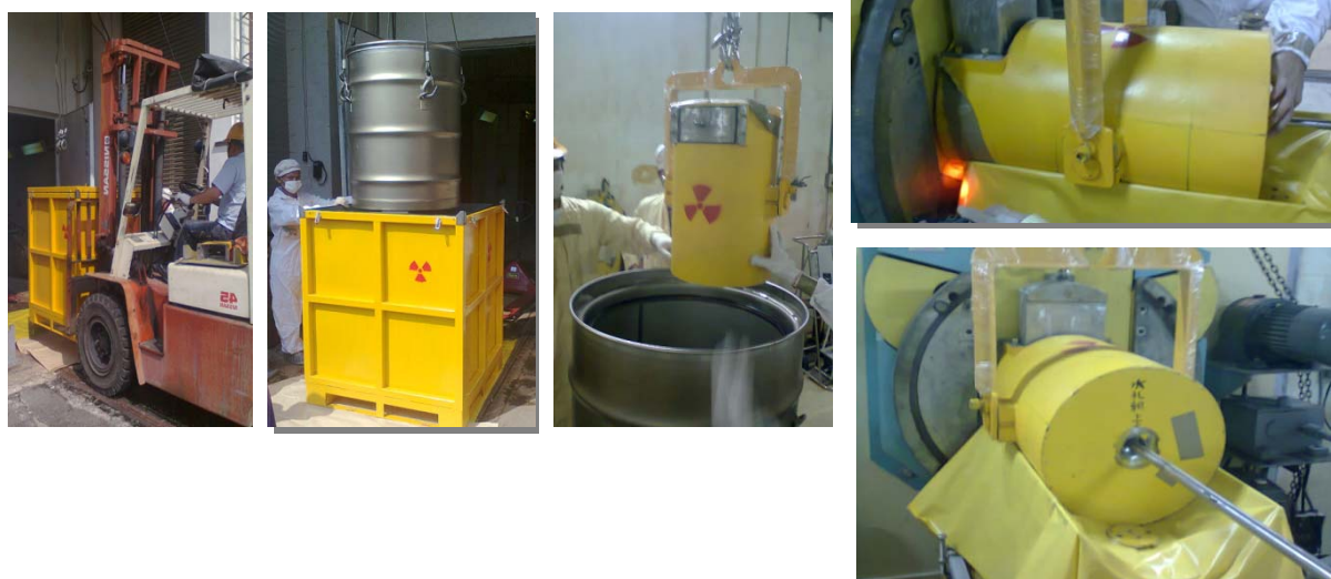
TRR 燃料池鈾粉運送熱室
