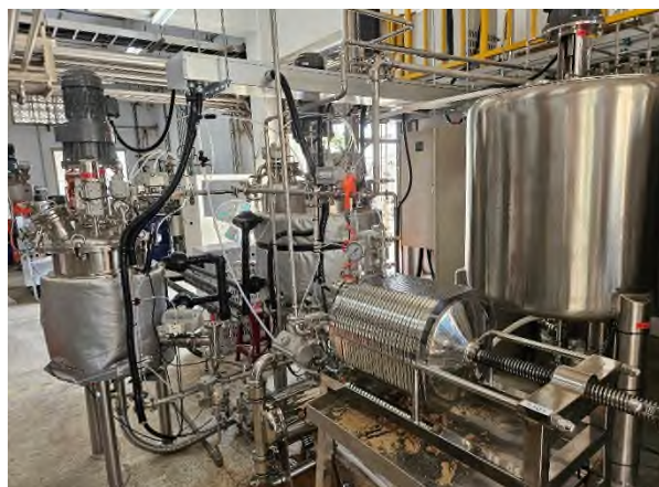
圖 4. 公斤級木質素萃取設備設計暨實貌
