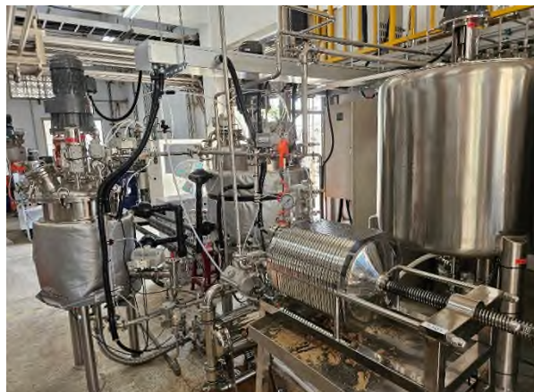
圖 4. 公斤級木質素萃取設備設計暨實貌
