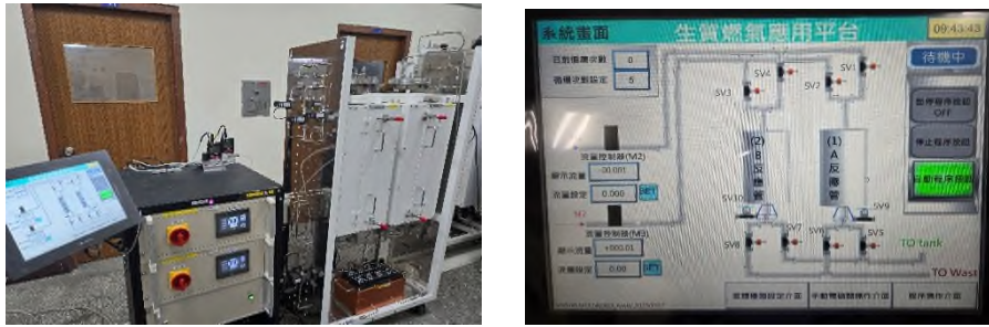
圖 10. m^3/h 等級生質沼氣應用平台實際照片(a)系統主體(b)人機介面控制
