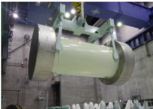
圖 32 (a)專門用於傳送用過核子燃料的多軸運輸車輛；(b)多軸運輸車輛於貯存庫檢查區內進行吊裝作業；(c)使用起重設備將護箱吊至垂直支架上；(d)垂直支架安裝作業[21]
