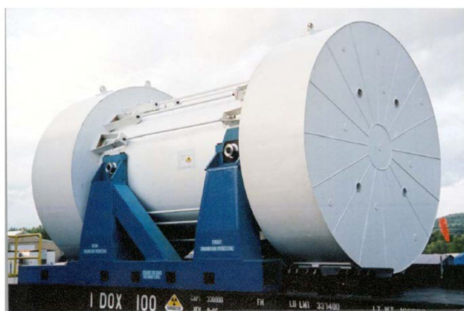
圖 4 裝有 TN-REG 運輸護箱及緩衝器的列車，執行 DOE 擁有商用用過核子燃料運輸任務，由西谷示範計畫區(West Valley Demonstration Project, WVDP)至愛達荷工程與環境實驗室(Idaho National Engineering and Environmental Laboratory, INEEL)
