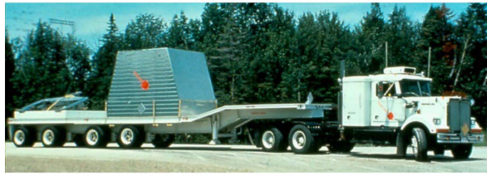
圖 12 加拿大用過核子燃料運輸護箱(左)裝載後重量約 35 公噸，以及完成裝載於曳引車上之狀態(右)
