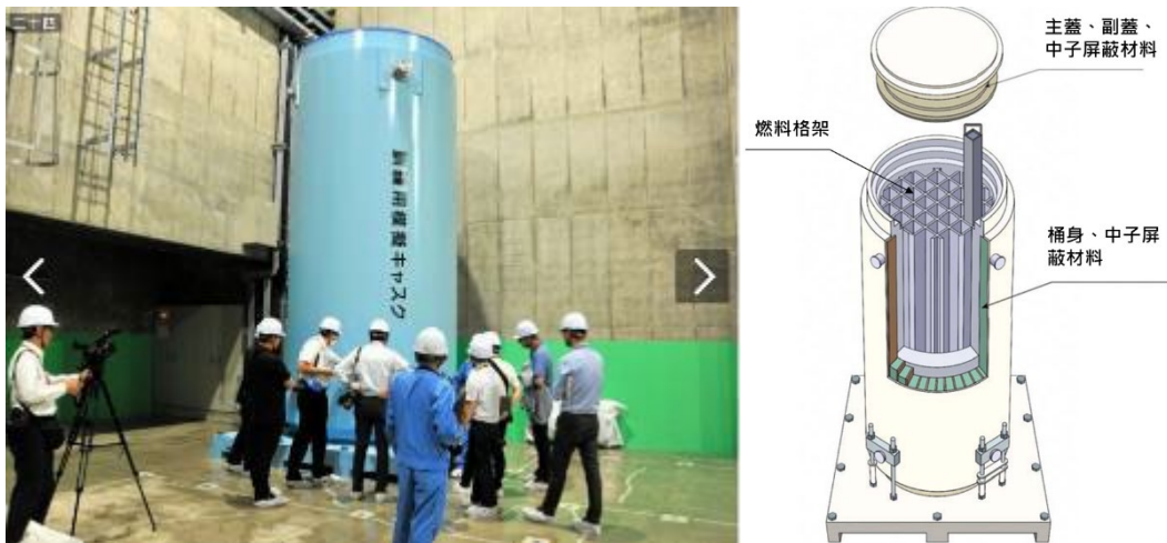
圖 28 (左)訓練用的護箱以螺栓固定在地板上，(右)貯存及運輸兩用金屬護箱的結構圖[17]
