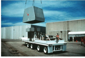
圖 12 加拿大用過核子燃料運輸護箱(左)裝載後重量約 35 公噸，以及完成裝載於曳引車上之狀態(右)
