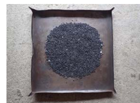
廢活性碳焚燒前
