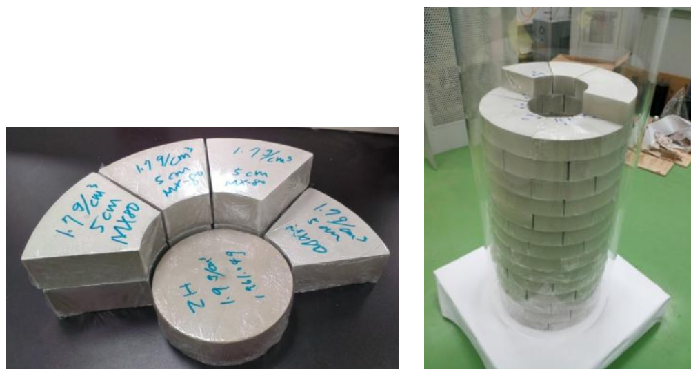
緩衝材料塊體壓製與塊體堆疊
