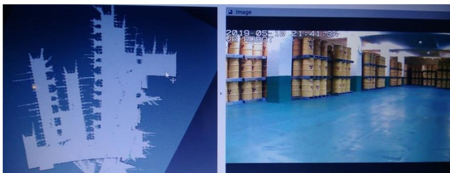
圖 2.1.5 原型機於輻射場域偵測任務之地圖建構圖
