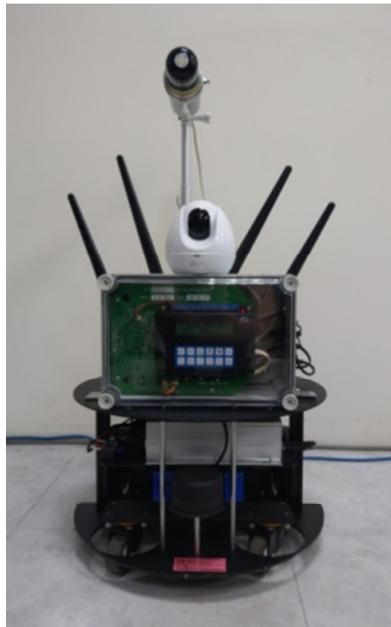
圖 2.1.2 智慧輻射偵測載具原型機
