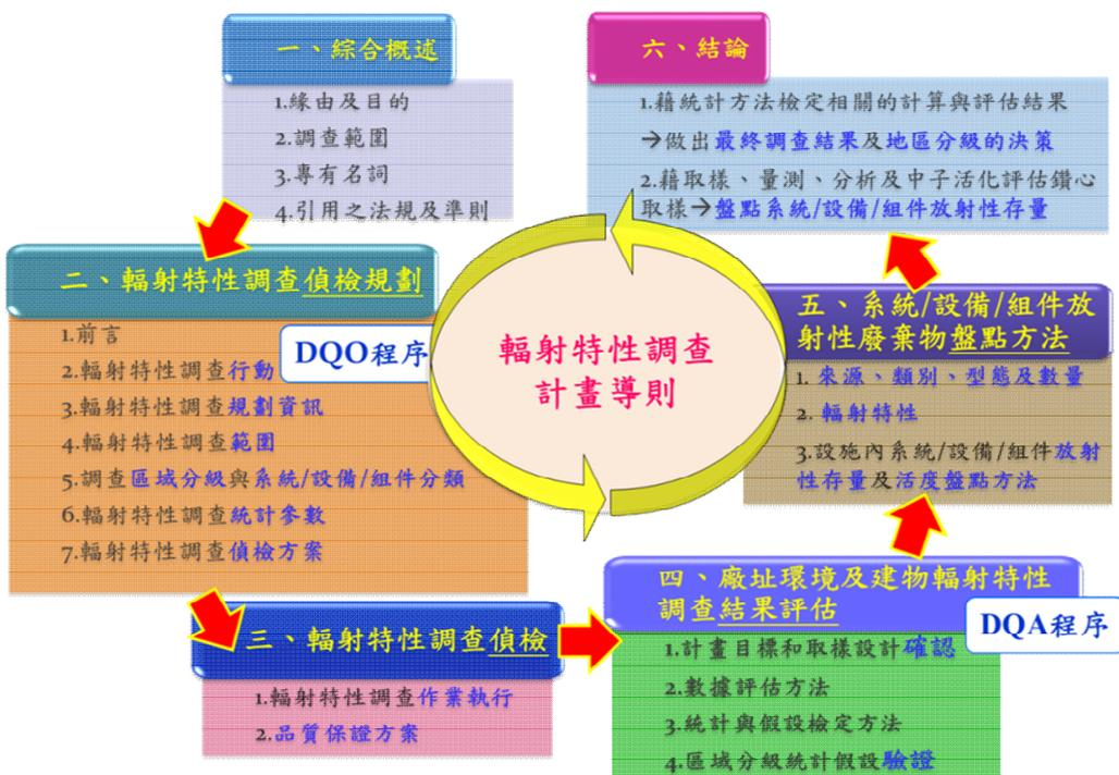
圖 2.4.3 核子反應器設施除役輻射特性調查偵檢計畫導則內容
