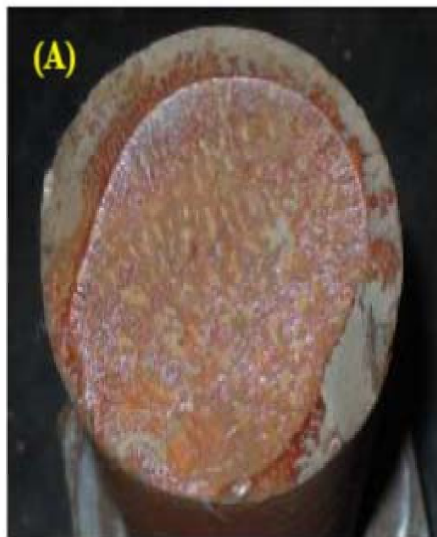
(圖4為A2螺栓斷面照片，(A)為原始形貌，(B)為清理後形貌；I為破斷起裂源，A為龜裂成長區，F為最終拉斷區)
